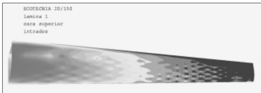
Figura 8. Mapa de tensiones absolutas sobre la pala del rotor Ecotecnia 20/150 en el punto de funcionamiento óptimo. Cabe notar cómo las tensiones aumentan al acercarnos a la raíz de la pala.
